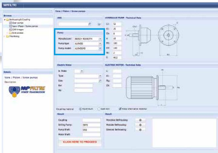
**Step 3** Selezionare il numero di poli del "Motore Elettrico": selezionare "Tipo motore elettrico" e "Grandezza motore elettrico"
