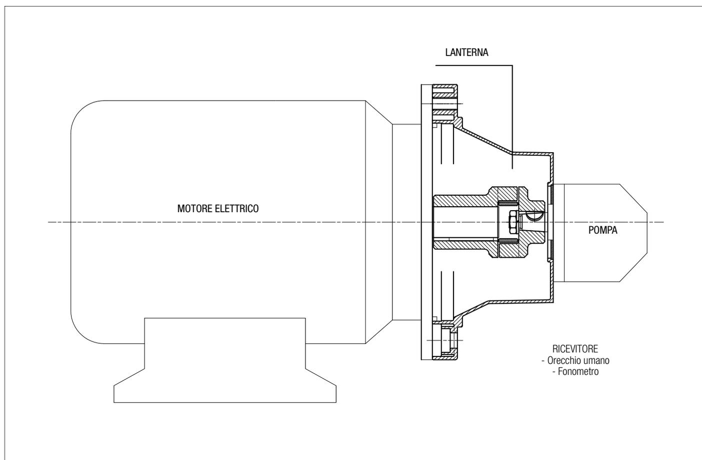
Le lanterne silenziate contribuiscono ad abbassare la trasmissione delle vibrazioni ed il livello di rumorosità dell'impianto.
