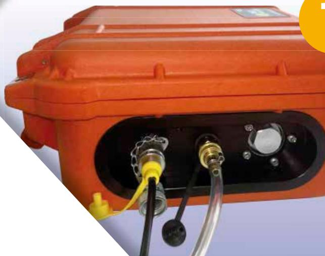
Punto di prova della pressione e scarico in uso
