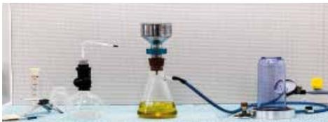
Il **"cuore"** del centro è la **struttura del banco prova** appositamente progettata per convalidare le caratteristiche operative e le prestazioni di filtri ed elementi filtranti. Queste stazioni di lavoro avanzate offrono una precisione puntuale nella misurazione del livello di contaminazione da particelle solide negli oli sotto pressione.
