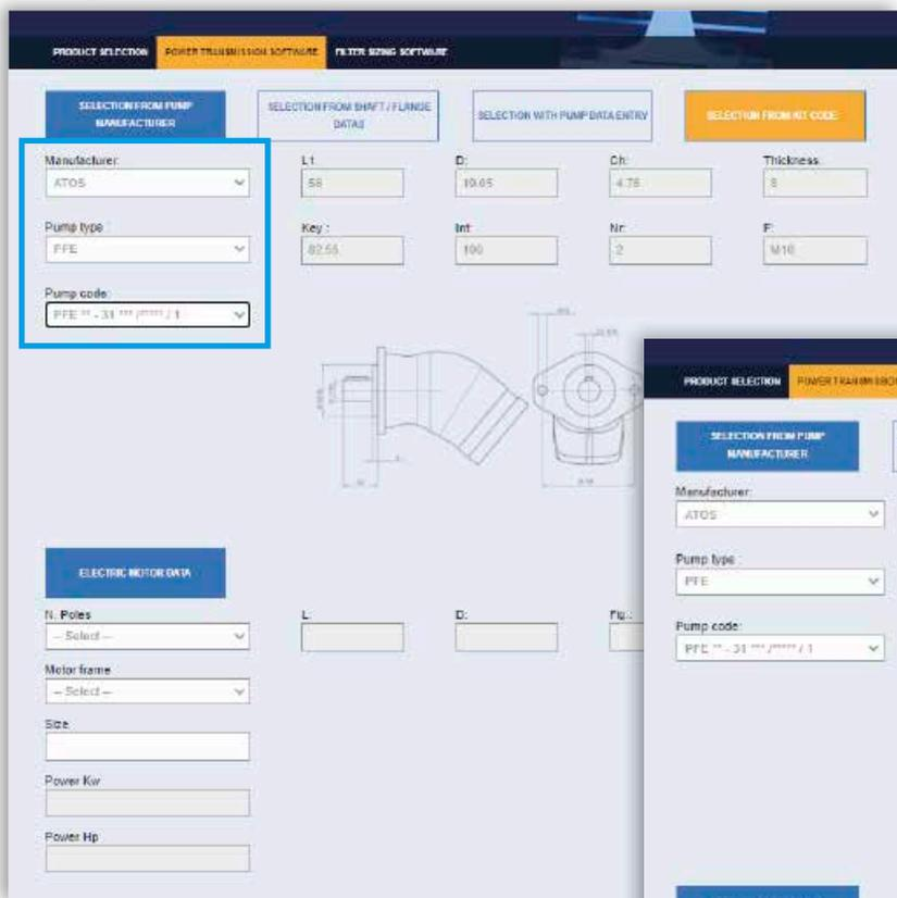
**Step 3** Selezionare il numero dei poli del "Motore Elettrico": selezionare "Forma Costruttiva" e "Grandezza motore elettrico"
