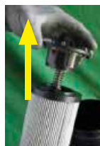
Retirer la coupelle bypass ou borgne
