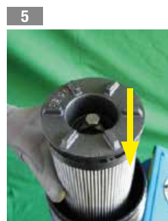
Inserire l'elemento filtrante nel corpo filtro
