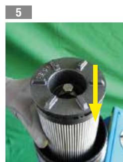
Inserire l'elemento filtrante nel corpo filtro
