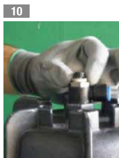
7 Inserire il codolo con bypass (fig.27) o l'eventuale codolo cieco (fig.28) nel nuovo elemento filtrante Fig.27
