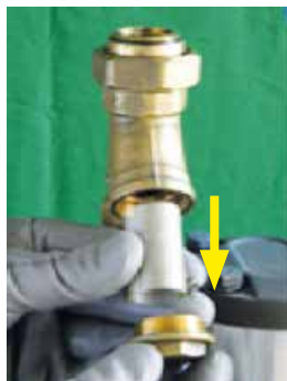
Svitare il dado e sfilare l'elemento filtrante
