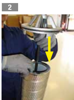
2 Inserire il cavalletto nell'elemento filtrante
