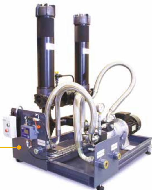
Sistema di filtrazione del serbatoio di stoccaggio con ICM & quadro elettrico
