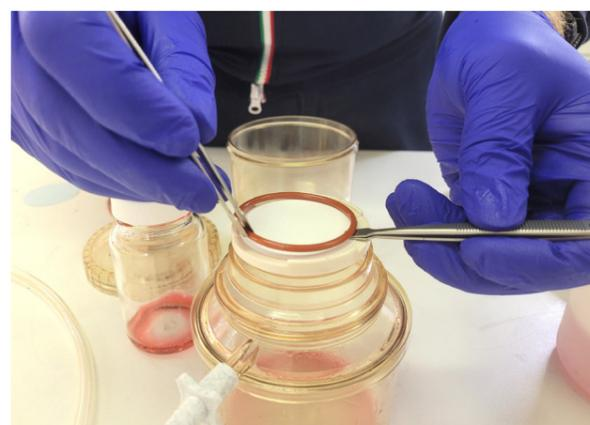
**4.2.5** Staccare con estrema cautela la copertura protettiva dalla membrana filtrante da 1,2 micron e 47mm di diametro, assicurandosi di non toccare la membrana.
