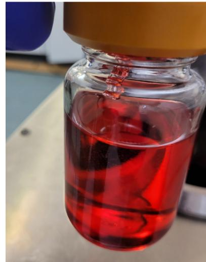
**4.1.10** Svitare con cautela il flacone dalla pompa a mano e riavvitare il coperchio del flacone il più presto possibile per evitare l'ingresso di eventuali infiltrazioni di contaminazione dall'atmosfera. Se è necessario un altro campione (dalla stessa fonte di fluido) ripetere il punto 4.1.3 e quindi eseguire i punti 4.1.7 - 4.1.10
