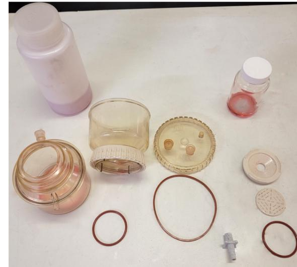
**4.3.1** Smontare completamente il portafiltro Nalgene. Rimuovere o-ring e cappucci.
