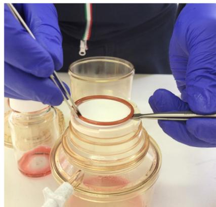
**4.2.24** Prima di eseguire ulteriori test, sarà necessario pulire tutte le parti bagnate. Questa operazione potrà essere eseguita utilizzando la bottiglietta spray per il solvente e panni privi di pelucchi. Le parti bagnate da pulire sono: le superfici interne del serbatoio superiore, la piastra di supporto per l'analisi (da entrambe le parti) e l'o-ring della piastra di supporto (che si trova nella scanalatura alla base del serbatoio superiore).
