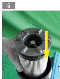
Inserire l'elemento filtrante nel corpo filtro
