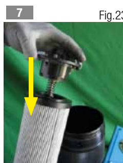
7 Inserire il codolo con bypass (fig.23) o l'eventuale codolo cieco (fig.24) nel nuovo elemento filtrante
