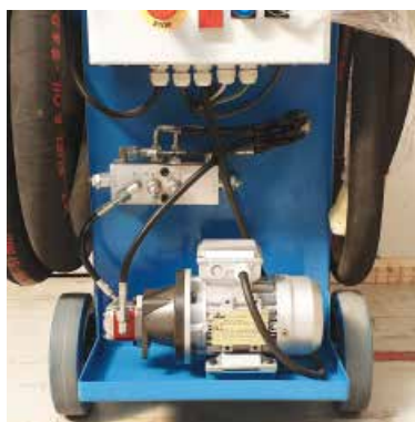
Gruppo motore/pompa e valvole di massima per l'utilizzo del contatore di particelle
