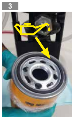
3 Lubrificare la guarnizione della cartuccia con il fluido di utilizzo
