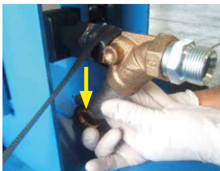
Svitare il dado e sfilare l'elemento filtrante
