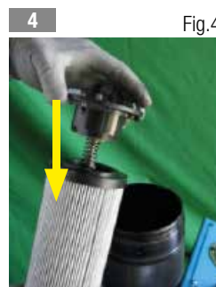
Inserire il codolo con bypass (fig.4) o l'eventuale codolo cieco (fig.5) nell'elemento filtrante
