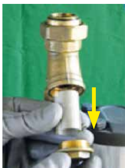
Svitare il dado e sfilare l'elemento filtrante
