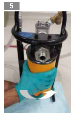
5 Avvitare la cartuccia fino a quando la guarnizione arriva a contatto con la testata e ruotare di mezzo giro
