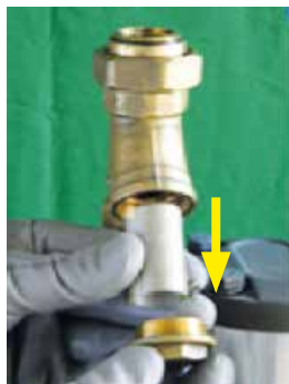
Svitare il dado e sfilare l'elemento filtrante
