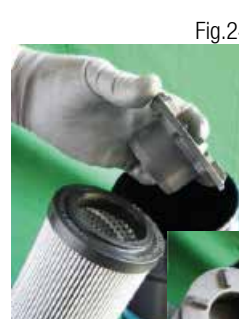
7 Inserire il codolo con bypass (fig.23) o l'eventuale codolo cieco (fig.24) nel nuovo elemento filtrante
