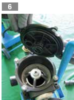
6 Verificare il corretto posizionamento del cavalletto/molla/coperchio e chiusura filtro
