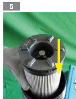
Inserire l'elemento filtrante nel corpo filtro
