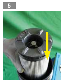
Inserire l'elemento filtrante nel corpo filtro
