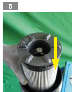
5 Inserire l'elemento filtrante nel corpo filtro
