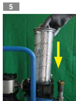
5 Inserire l'elemento filtrante nel filtro
