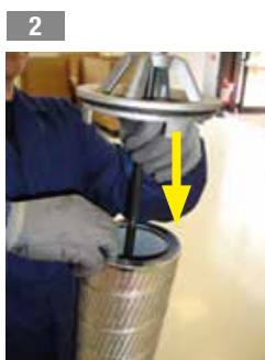
2 Inserire il cavalletto nell'elemento filtrante
