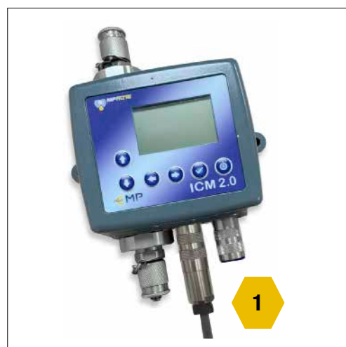
Figura 6.2 Posizione del cavo di alimentazione su ICM2.0
