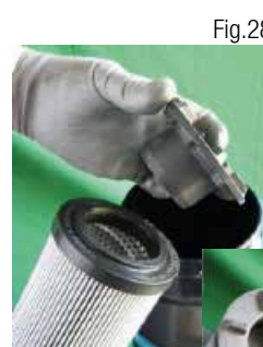
4 Sfilare l'elemento filtrante
