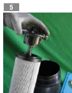
5 Sfilare il bypass o codolo cieco
