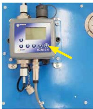
Attivazione manuale del conteggio delle particelle
