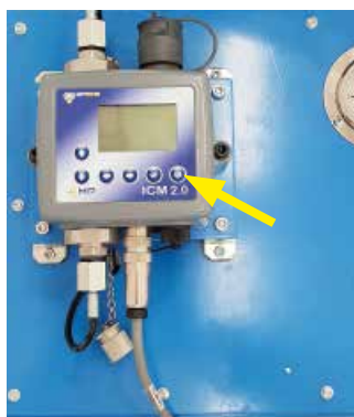
Attivazione manuale del conteggio delle particelle
