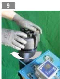
6 Assicurarsi che il contenitore sia ben serrato
