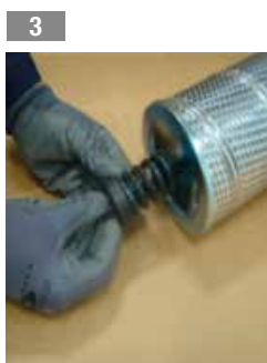
3 Inserire la molla bypass
