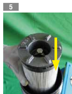
Inserire l'elemento filtrante nel corpo filtro
