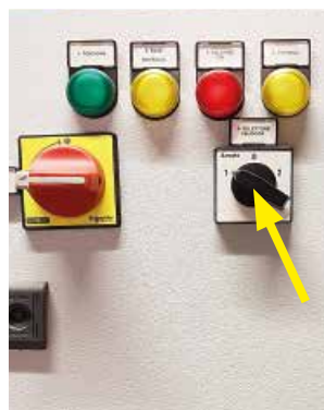
Invertitore di fase solo versione con contatore di particelle ICM2.0
