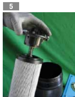
5 Sfilare il bypass o codolo cieco
