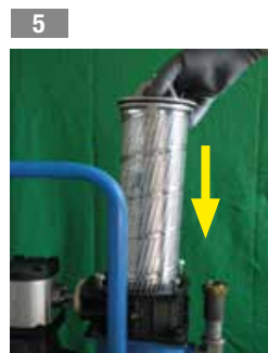
5 Inserire l'elemento filtrante nel filtro
