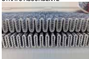
Il setto filtrante che ha assorbito l'acqua
