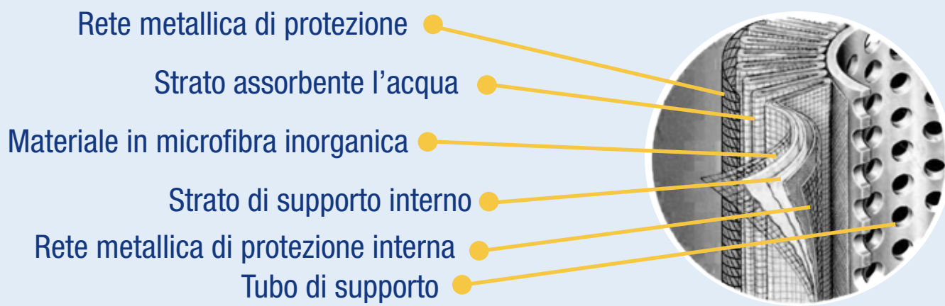
Il setto filtrante che ha assorbito l'acqua
