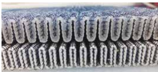
Il setto filtrante che ha assorbito l'acqua
