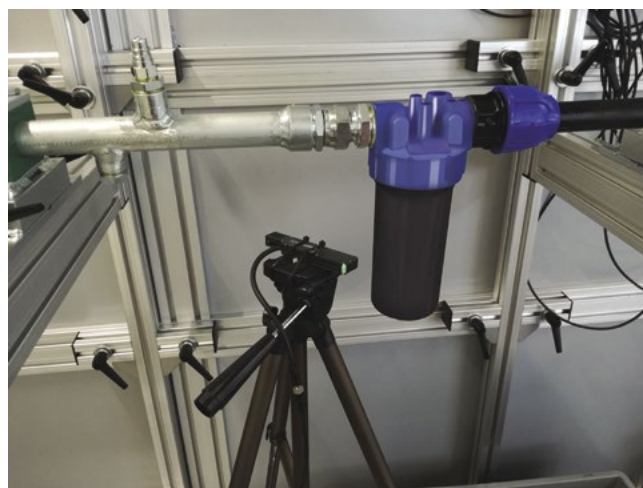
➤ FIG. 7 - VOLTMETRO CHE MISURA IL POTENZIALE DEL FILTRO
